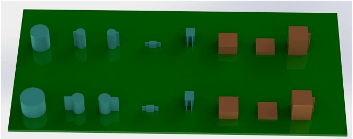
Figure 4: idfcyl と idfrect ツールで生成されたアウトラインのサンプルと SolidWorks によるレンダリング
