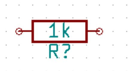
12. 別の抵抗器を配置するには、抵抗器を置きたい場所を単にクリックします。コンポーネント選択のウィンドウが再び表示されます。
