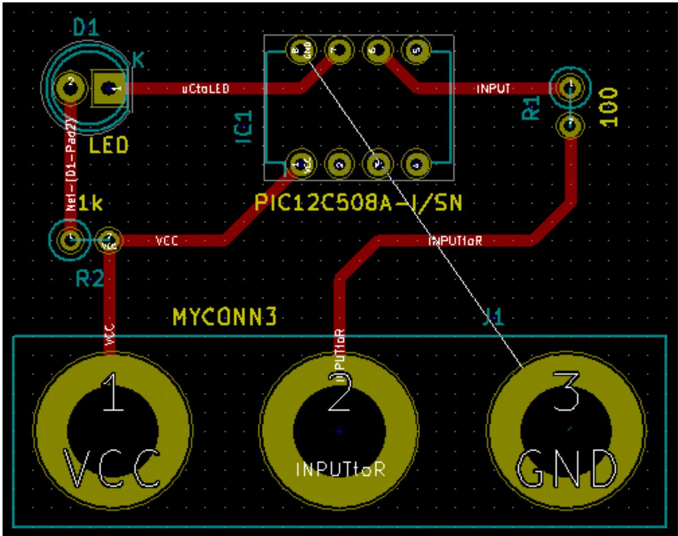
20. PCB の他の銅箔面側での配線を行いましょう。トップツールバーにあるドロップダウンメニューで *B.Cu* ("PgDn" キー) を選択します。'配線とビアの追加' のアイコン
