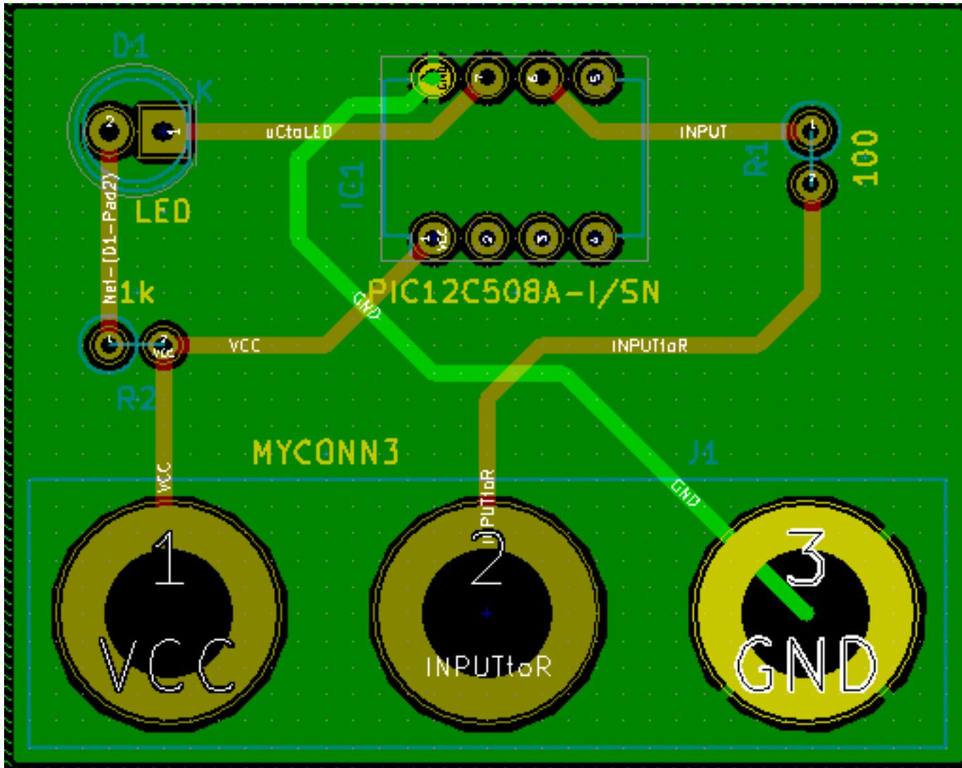
25. トップツールバーにある デザインルールチェックの実行のアイコン
