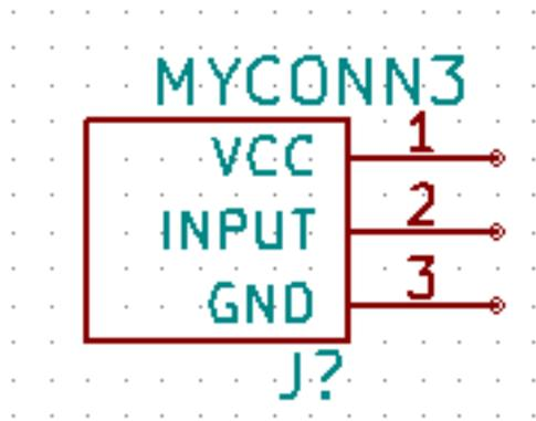
26. 電源と GND のシンボルを配置します。右ツールバーにある 電源ポートの配置ボタン
