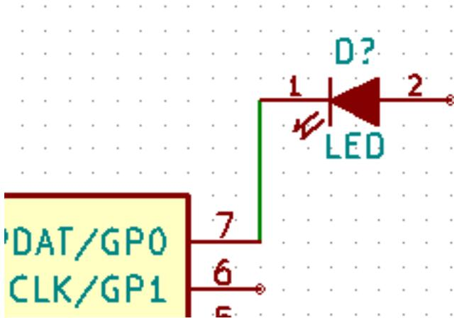
31. この処理を繰り返して以下の全てのコンポーネントの配線を済ませます。ワイヤを終端するにはダブルクリックをします。VCC と GND のシンボルへの配線は、VCC シンボルなら下部に、GND シンボルなら上部中央にタッチします。下のスクリーンショットを見てください。
