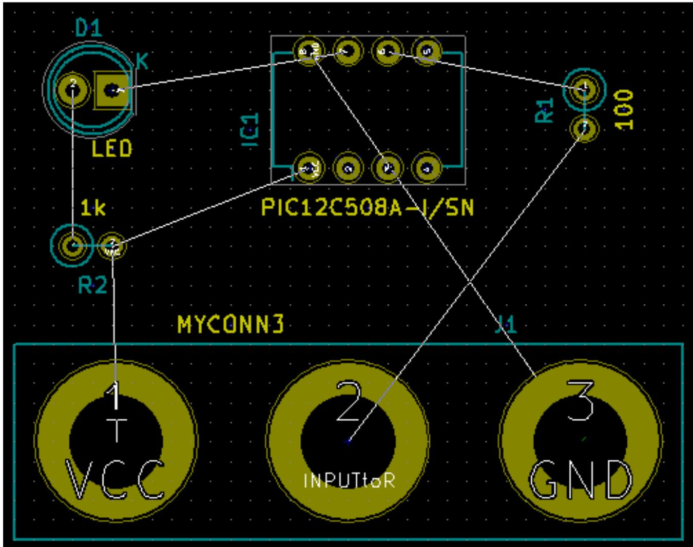
10. ラッツネストが消えたり画面が乱れてきた場合には、右クリックしてビューの再描画をクリックします。どのように 100Ω の抵抗器のピンが PIC コンポーネントのピン 6 に接続されているかに注意しましょう。これがピンを接続するのに使ったラベル付けの結果です。ラベルは実際のワイヤより好まれます。実際のワイヤは回路図を乱雑にするからです。
