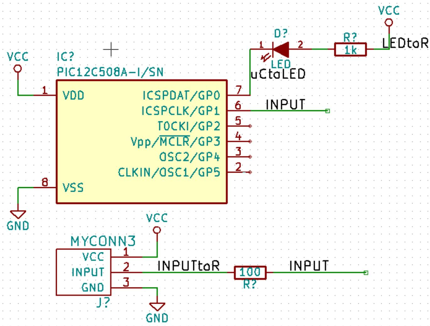
38. それでは接続されていないワイヤに対処しましょう。接続されていないピンやワイヤは KiCad にチェックされた時に警告されます。これらの警告を避けるため、ワイヤが接続されていないのが意図的であることをプログラムに指示することができます。
