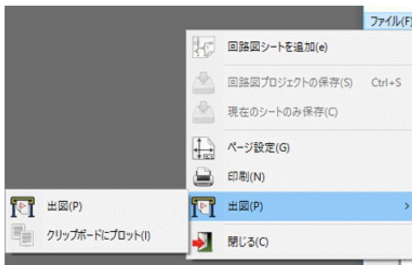
出図でサポートしている出力フォーマットは、PostScript、PDF、SVG、DXF、HPGL です。自分のプリンターで直接印刷することも可能です。
